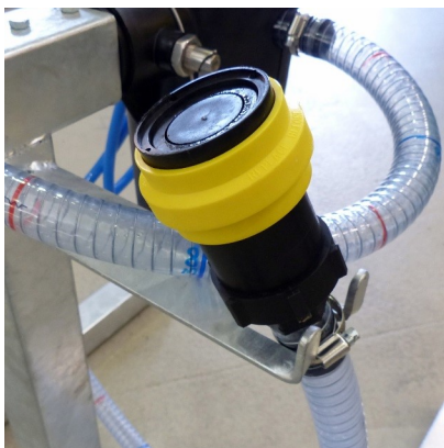
Abb. 4: Der 1" Saugschlauch ist über den Sauganschluss tropffrei an das Pflanzenschutzgerät kupplbar.
