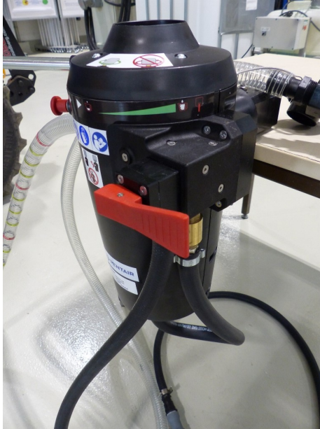
Abb. 2: Der verschlossene Behälter wird durch das System gehalten und dicht verschlossen. Durch Drehen des Dosierhandgriffes kann das PSM mehr oder weniger schnell eingesaugt werden.
