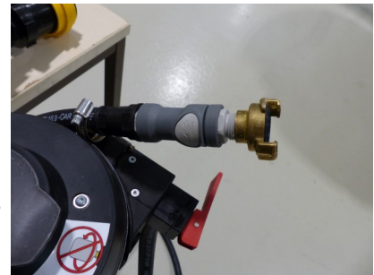
Abb. 3: Der Druckwasseranschluss kann über die mitgelieferte Druckkupplung mit Gewinde erfolgen. Auf das Gewinde (3/4") können passende Anschlussstücke (z.B. GEKA) aufgeschraubt werden.
